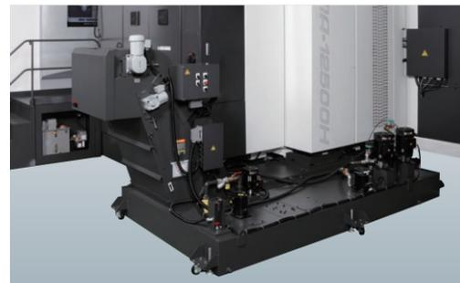
铰链式+刮板式(带滚筒过滤器)提升式排屑器
