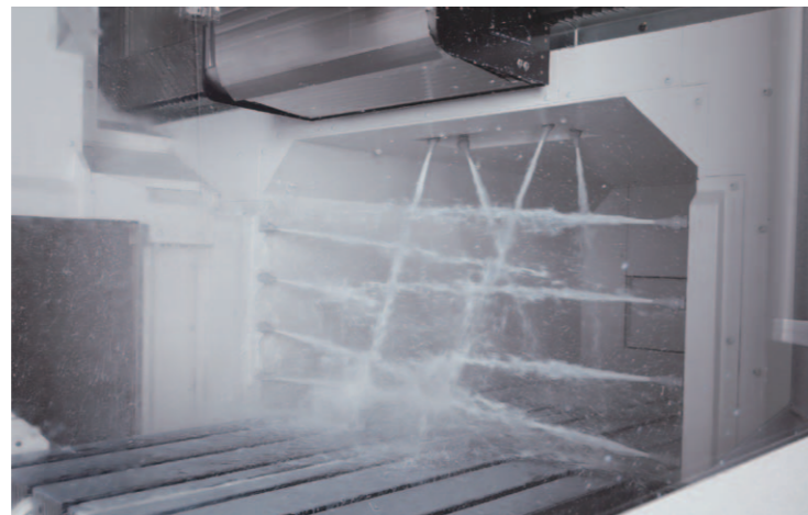
通过横梁喷淋洗净 (特殊规格) 工件, 清扫工作台上的切屑
