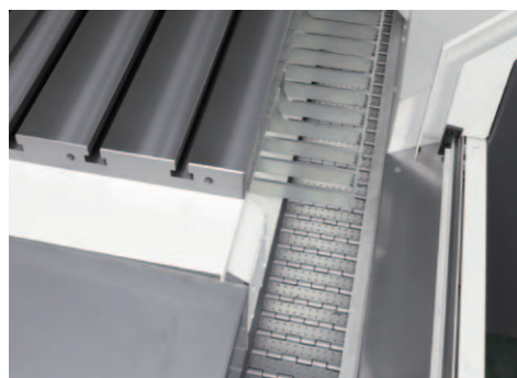
在工作台前设置宽敞的机内铰链式排屑器。即使大量切屑也可顺利排出
